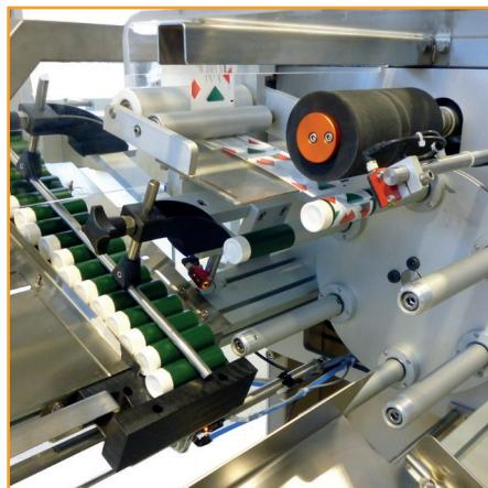
Es una solución innovadora diseñada para el etiquetado de tubos de cosméticos vacíos. El tubo, alimentado manual o automáticamente, es transportado al carrusel principal donde están alojados una serie de husillos que reciben el tubo y lo trasladan a las distintas estaciones. La aplicación de la etiqueta se confía a un LABELX 140 ES y a un sistema de rotación del producto con la posibilidad de orientación automática de la posición de la etiqueta respecto a la abertura del tapón.
